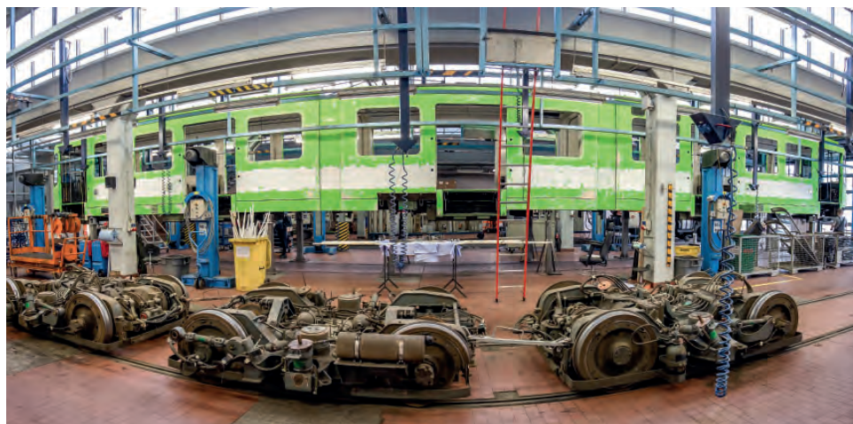
Der TW 6000 wird komplett aufgearbeitet.
