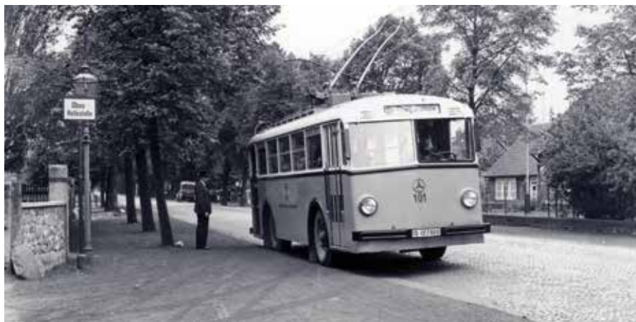
Ab Juni 1937 verkehrte zwischen Wiesenau und Langenhagen der Oberleitungsomnibus als Ersatz für die Straßenbahn.
